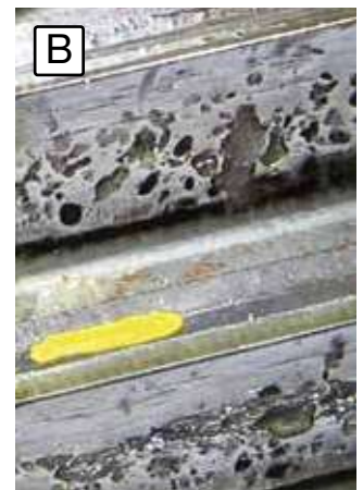
Bild B: Deutliche Einglättung 5 Monate nach der Umstellung auf Eco Gear 460 M
