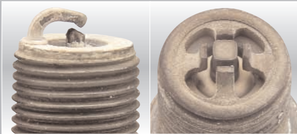
Usure totale Desgastada
