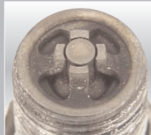
Calaminage Cubiertas de carbón
